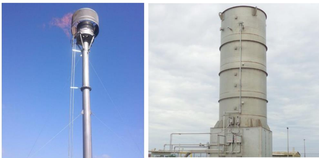
Figura 8 – Foto de um Flare de chama aberta (esquerda) e de chama enclausurada (direita).
